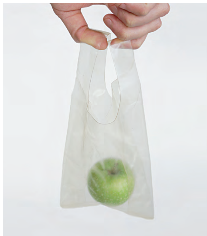
UNA BUSTA PER ALIMENTI CREATA CON IL SOSTITUTO DELLA PLASTICA MARINATEX OTTENUTO DAGLI SCARTI DEL PESCE E DELLE ALGHE (per gentile concessione MarinaTex)
